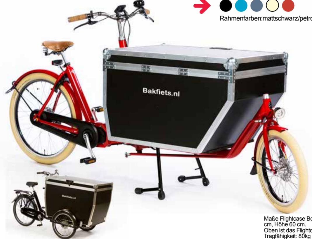
Maße Flightcase Boden: Breite 67 cm x Länge 91 cm, Höhe 73.5 cm. Oben ist das Flightcase 104 cm lang. Tragfähigkeit: 80kg
